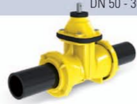
Задвижка с обрезиненным клином тип 4004 с трубными концами из PE 100 высокой плотности (также используется в качестве продувочного клапана)
